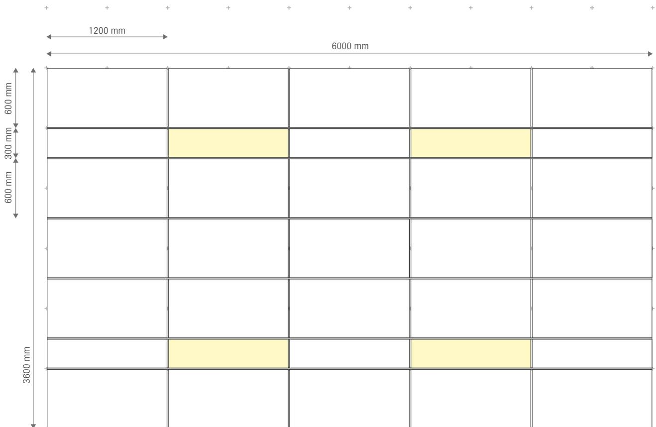
Verlegebeispiel | Lay-out Flexo 2, Flexo 3, Flexo LED 2
